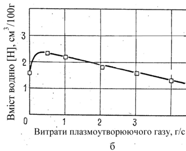
Рисунок 4 Вплив довжини дуги (а) і витрати плазмоутворюючого газу (б) на вміст водню в латуні P_{\text{H}_2\text{O}}^{\text{Ar}} = 0,007 \text{ кПа} ; P_{\text{H}_2\text{O}}^{\text{к}} = 1,104 \text{ кПа} ; P_{\Sigma} = 1,01 \cdot 10^2 \text{ кПа} ; I_d = 250 \text{ А}
