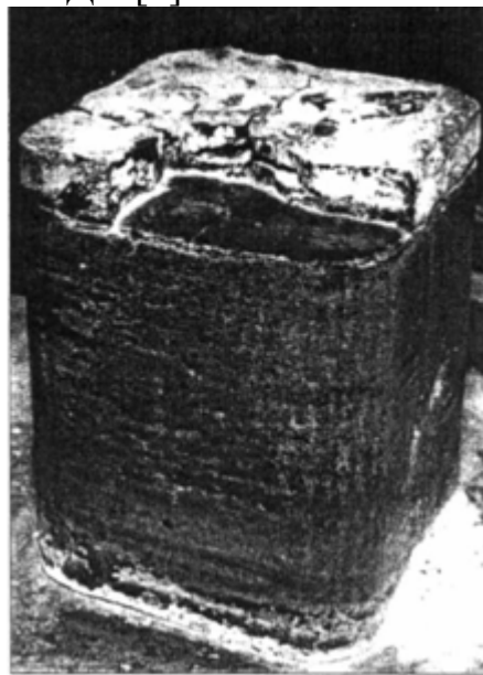
Рис. 1.4. Титановый слиток ДШП из титана ВТ1-0 квадратного сечения 200X200 мм, выплавленный под флюсом \text{CaP}_2
