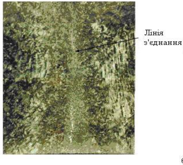
Рис.1 Макроструктура (x25) з'єднань інтерметаллідного сплаву складу Ti-47Al-1,5Cr-2Nb (ат.%), отриманих контактним стиковим зварюванням: з використанням фольги системи Ti-Al
