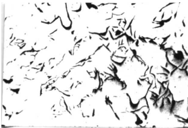
Рис. 7. Форма графіту у чавуні плавки №13 x 100.
