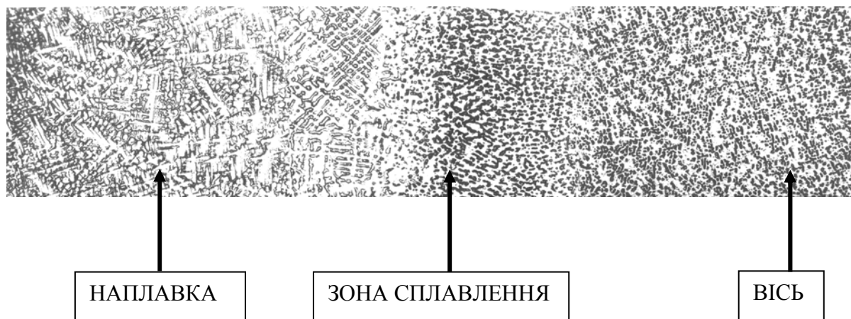
Рис. 3. Мікроструктура наплавленого модельного зливка (×50)
