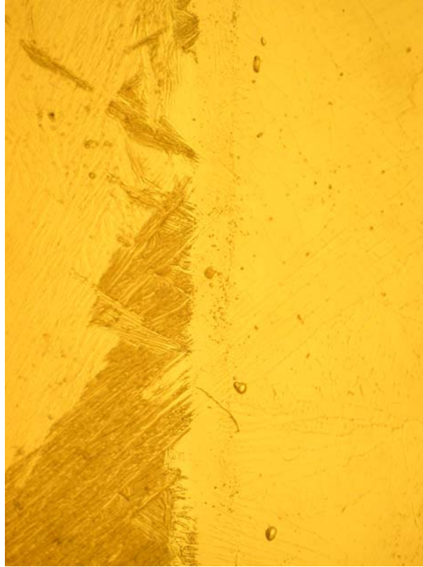
Рис. 2 Мікроструктура з'єднання сплаву алюмініду титану (Ti47Al1,5Cr2Nb) і сплаву титану VT6, отриманого з використанням фольги системи Ti-Al товщиною 60 мкм, збільшення x400
