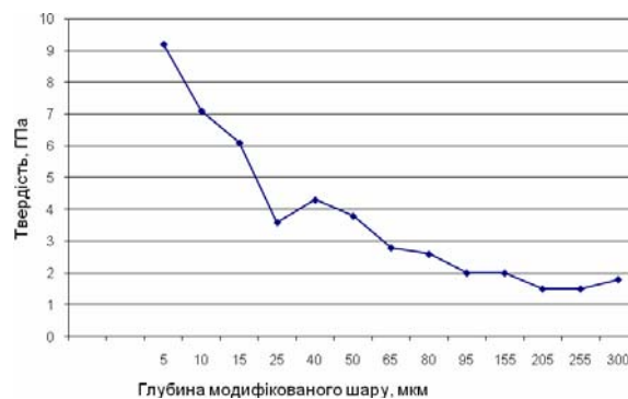
Рис. 3. Результати вимірювання твердості в поверхньому шарі зразка з титану ВТО-1 після ХТО в азотовмісткій плазмі
