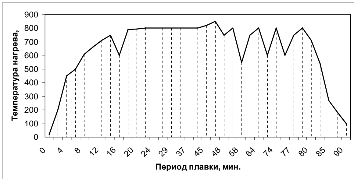
Рис. 2. Діаграма ведення плавки лігатури Al – Cu
