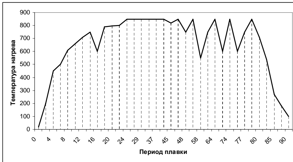
Рис.3. Діаграма ведення плавки лігатури Al – Fe
