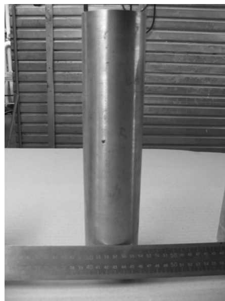
Рис. 2. Зовнішній вигляд зливка СДП-3, після механічної обробки поверхні.
