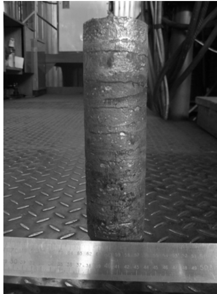
Рис. 1. Зовнішній вигляд зливка СДП-3, одержаного електронно-променевим переплавом.
