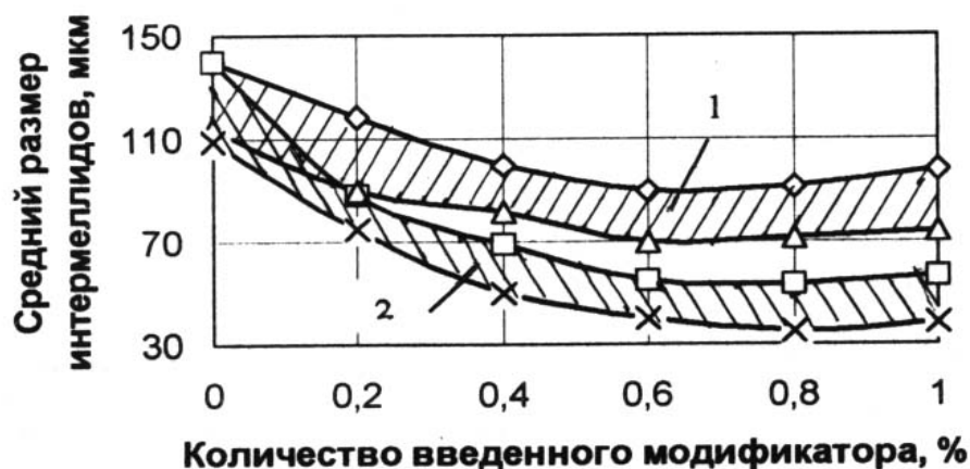
Рис. 3- Влияние внепечной обработки расплава алюминия на размер интерметаллидных включений сплава АК12М2:
