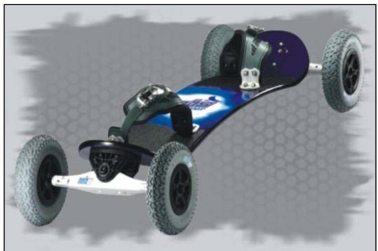
жки і до 30 сантиметрів шириною вагою 6-9 кілограмів і колесами діаметром близько 25 сантиметрів. Деякі моделі обладнуються гальмами, проте це швидше опція. Справжні професіонали гальмують, відправляючи дошку в кероване занесення, як при гальмуванні на сноуборді.
