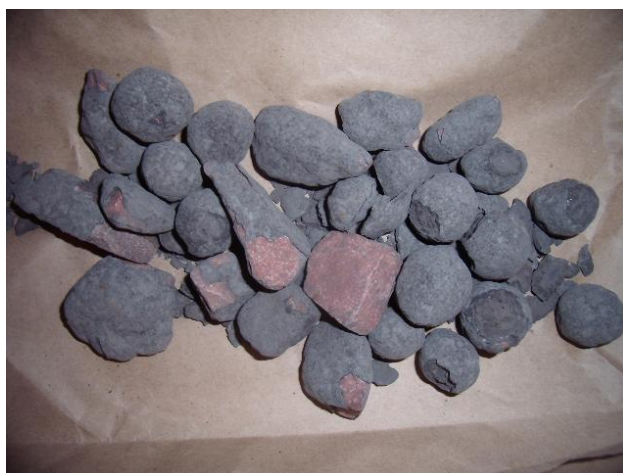
Рисунок 4 – Окатыши с ядром окомкования из кварцита, после сушки.
