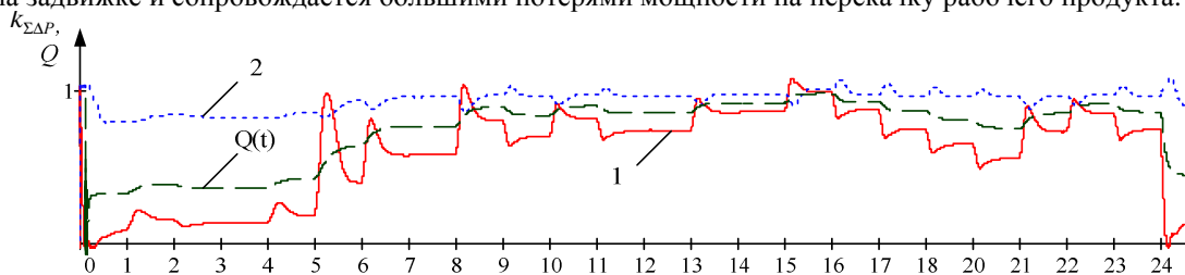
Рисунок 2 – Зависимость удельных суммарных потерь мощности в НК от времени при обеспечении переменного графика нагрузки изменением частоты вращения (1) и дросселированием (2)
