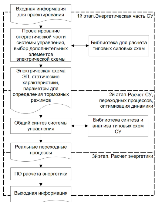
Рисунок 2 – Структура программного обеспечения для расчета энергетических характеристик электропривода
