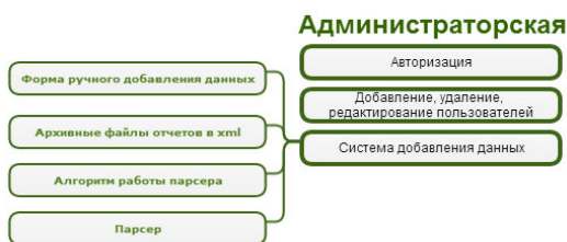
Рисунок 2 – Структурная схема администраторской части системы мониторинга тепловыми системами
