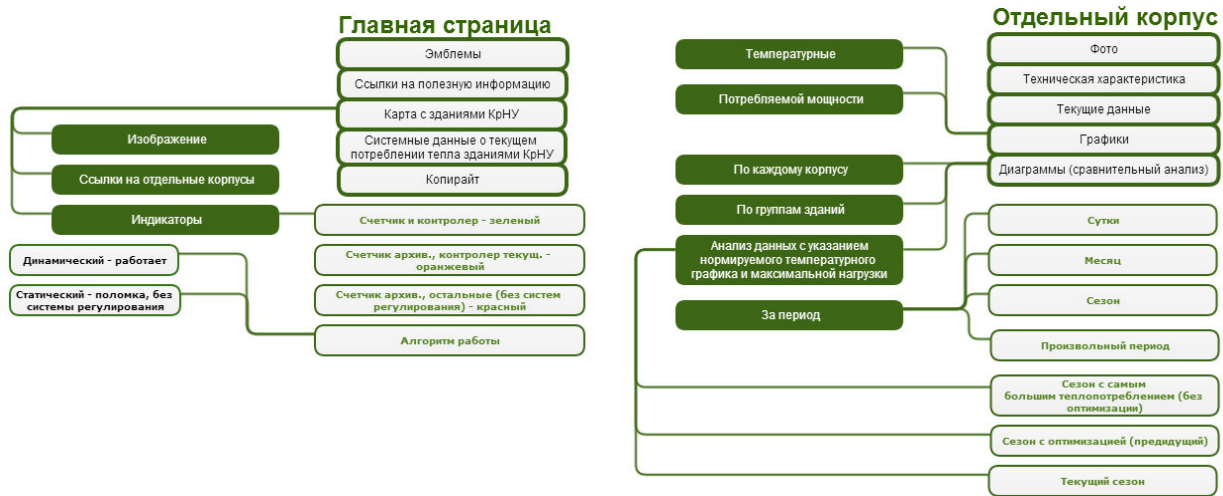
Рисунок 3 – Структурная схема пользовательской части системы мониторинга тепловыми системами
